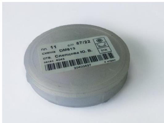
Рисунок 4.8 – Транспортная чашка с пластиной
