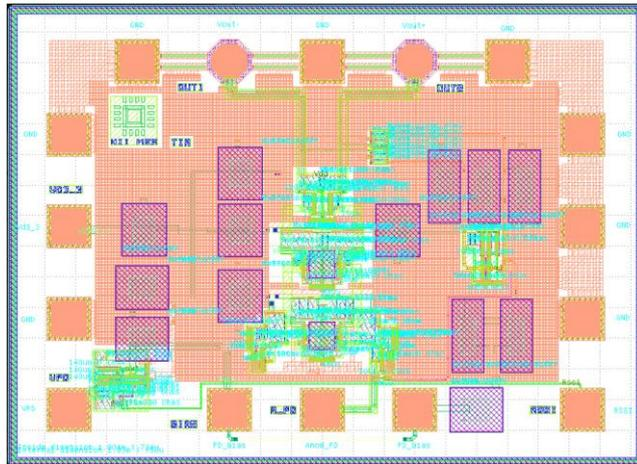
Рисунок 85 – Топология ИС ТИУ 2,5 Гбит/с на основе отечественной 180-нм КМОП технологии ( размеры чипа  $0,75 \times 1 \text{ мм}^2$  )
