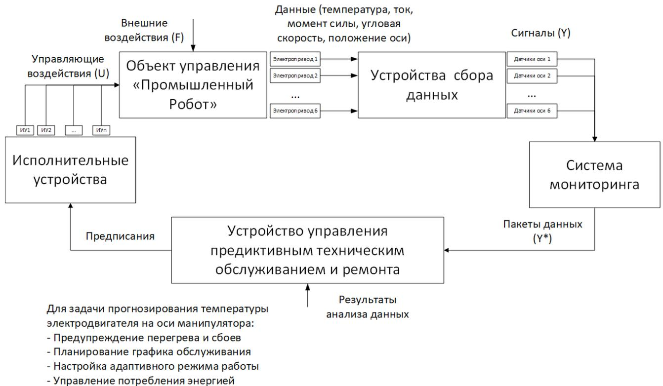
Рисунок 49 – Структурно-функциональная схема управления состоянием промышленного манипулятора на основе результатов прогнозирования температуры электропривода
