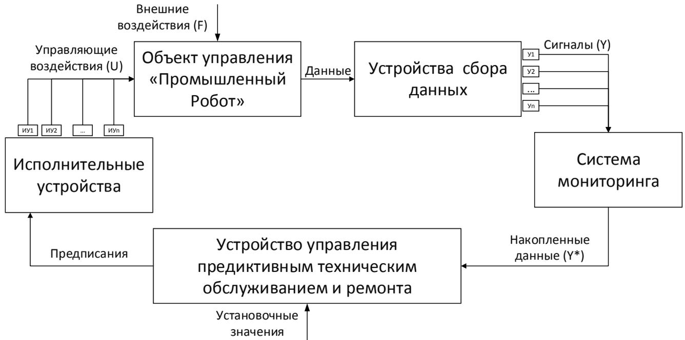
Рисунок 9 – Структурно-функциональная схема автоматизированной системы управления техническим обслуживанием промышленного робота
