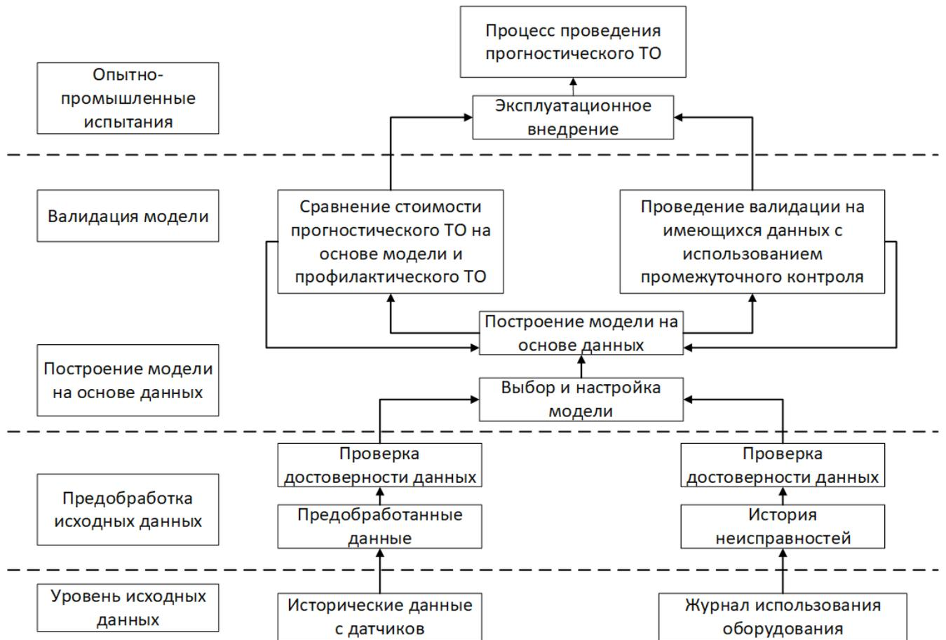
Рисунок 18 – Процесс проведения прогностического ТО на основе анализа данных
