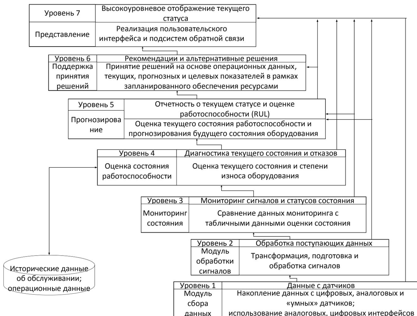
Рисунок 7 – Концептуальная архитектура рекомендательной системы для принятия решений на основе состояния оборудования
