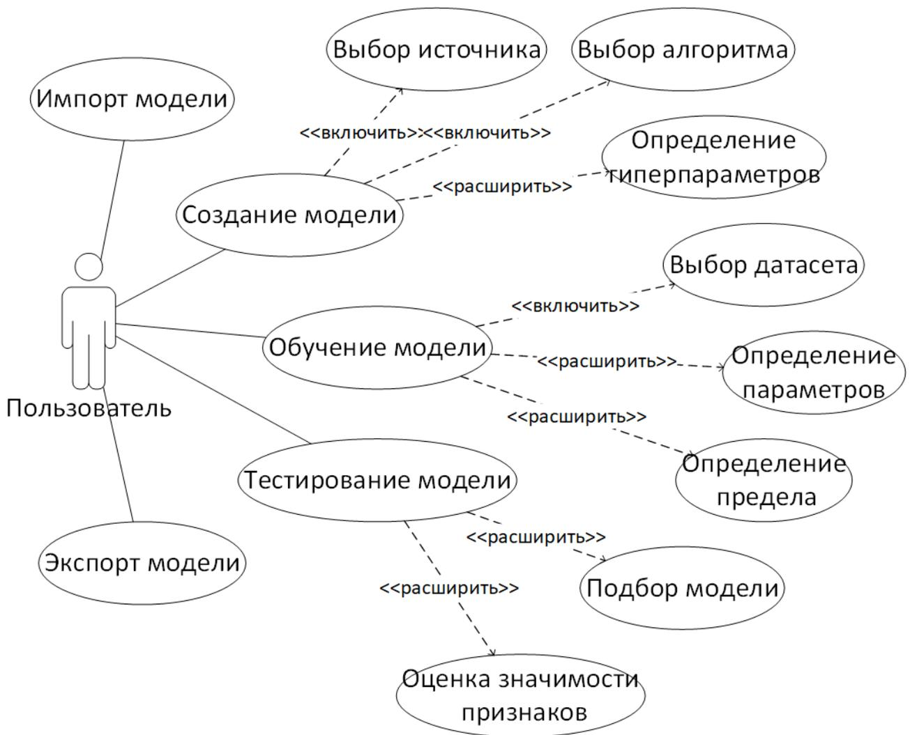
Рисунок 31 – Диаграмма вариантов использования модуля анализа данных
