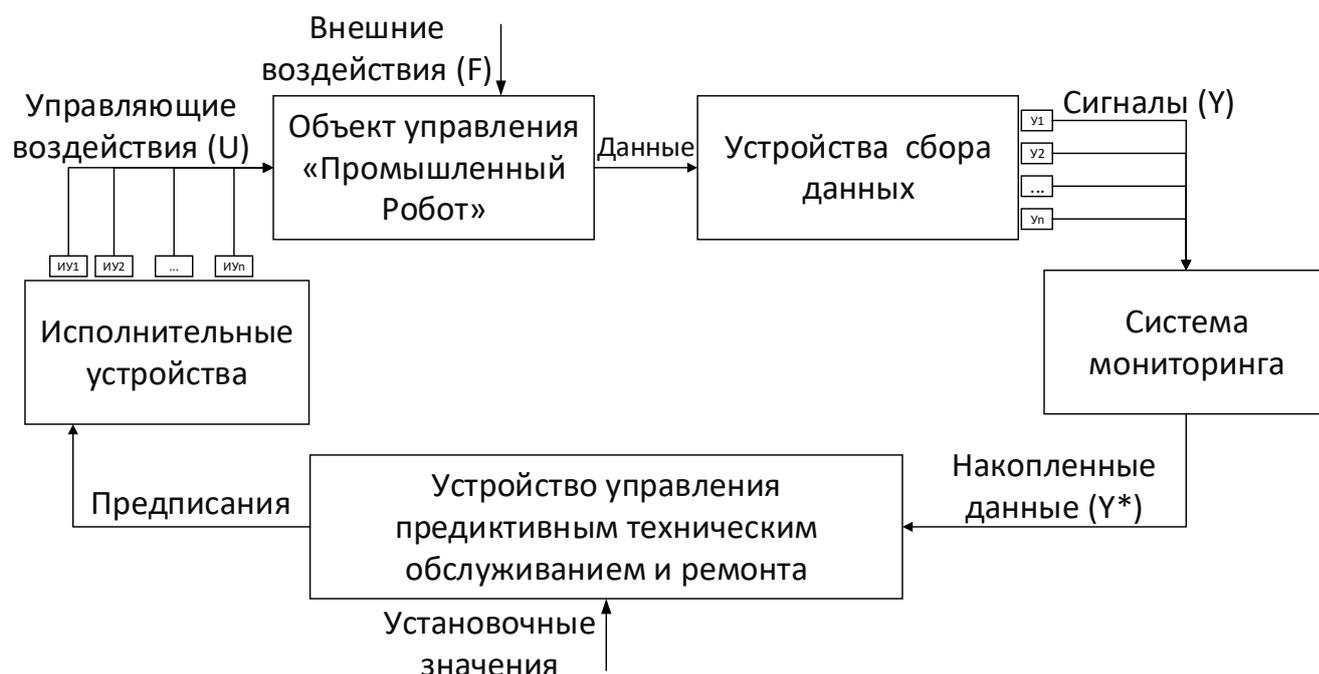
Рисунок 1 – Структурно-функциональная схема автоматизированной системы управления техническим обслуживанием промышленного робота
