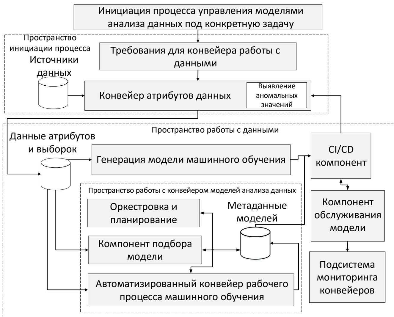
Рисунок 3 – Система автоматизации управления моделями анализа данных на основе конвейерного подхода
