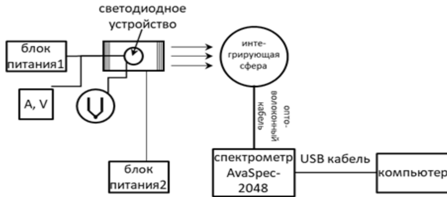
Рисунок 2.17 – Функциональная схема измерительного комплекса для проведения исследований температурных зависимостей
