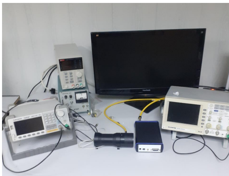
Рисунок 2.16 – Внешний вид установки для температурной калибровки полуширины спектра излучения
