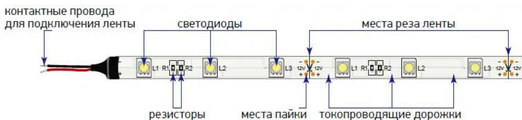
Рисунок 1.14 – Структурная схема PCB -светодиода с корпусом PLCC
