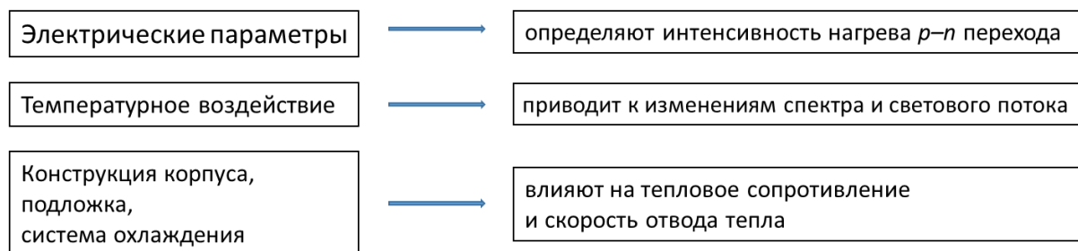
Рисунок 1.19 – Схема взаимосвязи факторов, влияющих на тепловой режим светотехнического устройства на основе полупроводникового источника света
