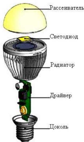
Рисунок 1.16 – Конструкция осветительного устройства – аналог лампы накаливания
