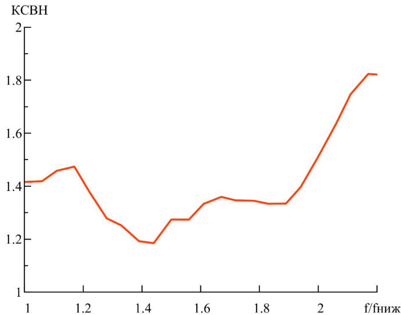
Рисунок 15 – Частотная зависимость КСВН, полученная для модели, приведенной на рисунке 14
