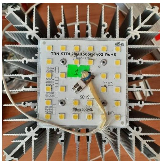
Рисунок 6 – Исследуемый светодиодный модуль на радиаторе с вертикально ориентированными ребрами охлаждения
