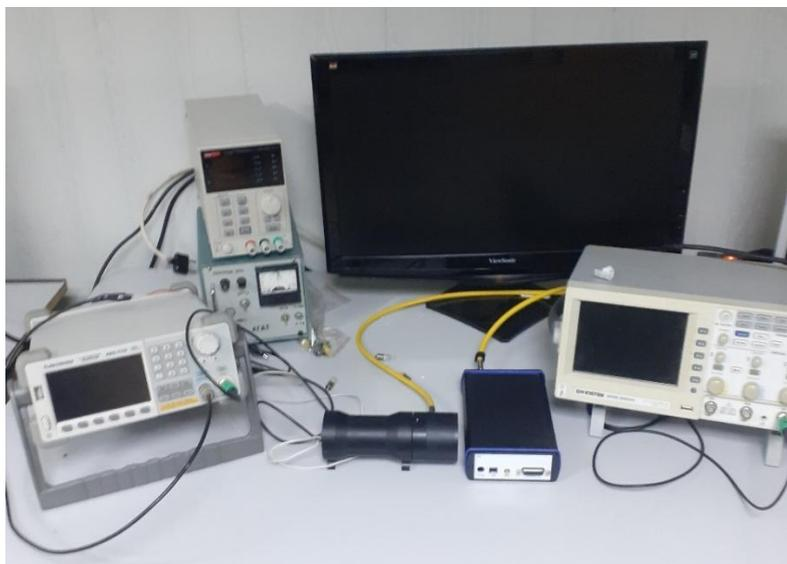
Рисунок 1 – Внешний вид комплекса для бесконтактных измерений температуры источников света
