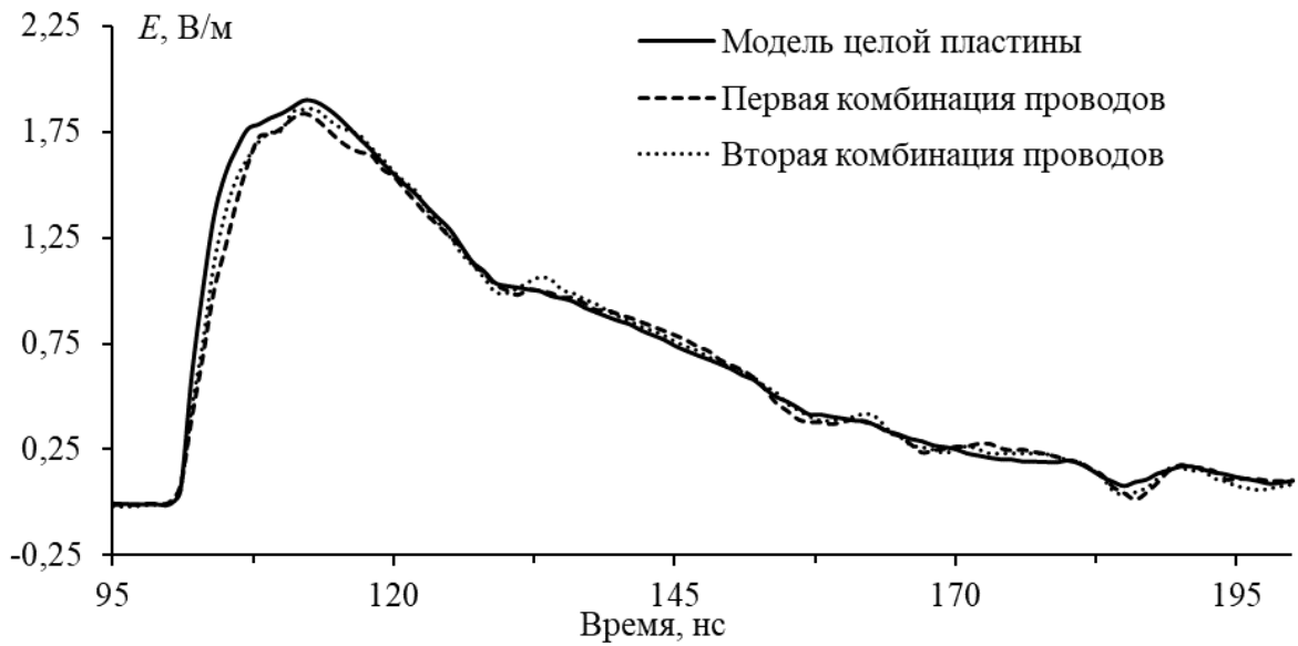
Рисунок 1.4 – Формы напряженности поля внутри симулятора для разных комбинаций проводов сетки [186]
