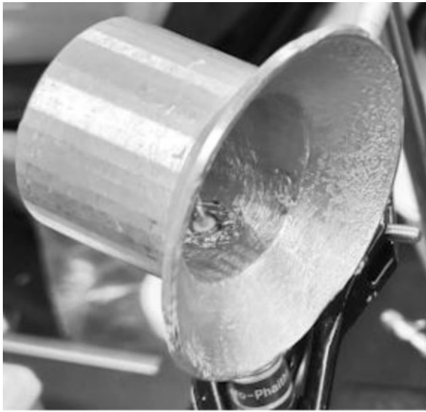
Рисунок 4.62 – Коническая рупорная антенна, изготовленная в [357] по технологии металлического литья ( a ) и аппроксимированная посредством ПС ( б )
