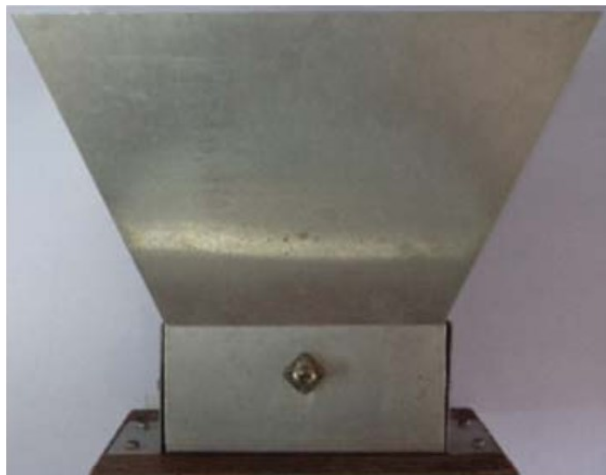
Рисунок 5.1 – Рупорная антенна со сплошной (а) и ПС (б) структурами
