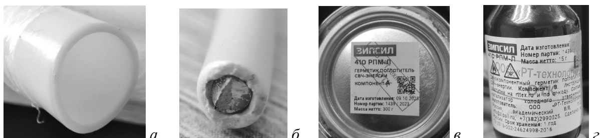
Рисунок 4.3 – Трубка фторопластовая (а), провод ПВ-1 (б) и РПМ (в, г)
