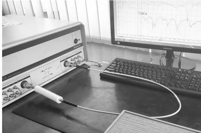
Рисунок 4.11 – Измерение частотных характеристик МФ без ПП с помощью ВАЦ Р4М-18
