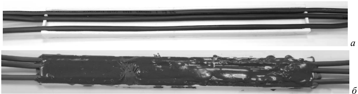
Рисунок 4.23 – Размещение проводов во фторопластовой форме (а) и их заливка РПМ (б)
