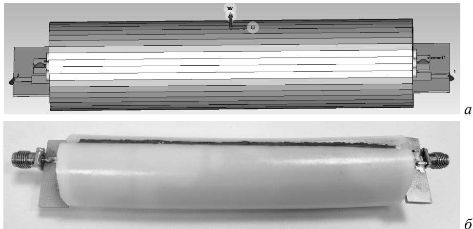
Рисунок 4.7 – Геометрическая модель МФ с ПП (а) и прототип МФ (б)
