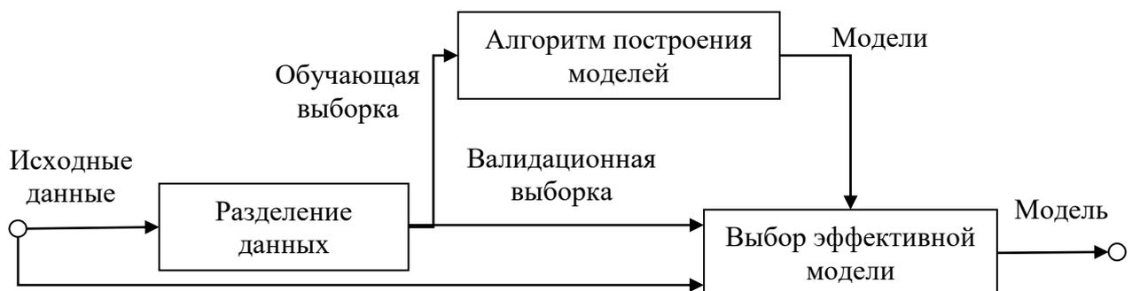
Рисунок 2.14 – Схема построения прогностических моделей с разделением данных
