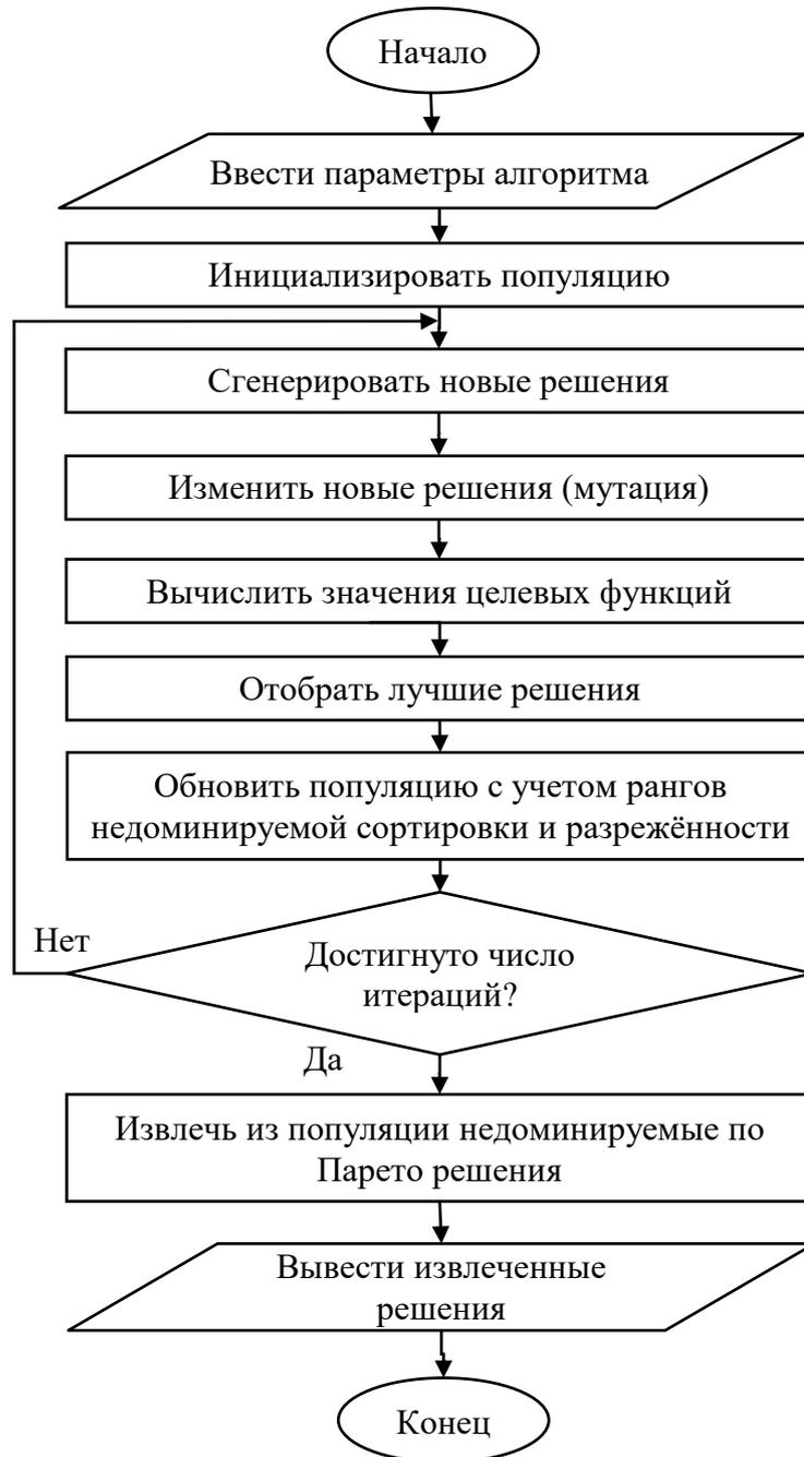
Рисунок 2.7 – Схема алгоритма MICS
