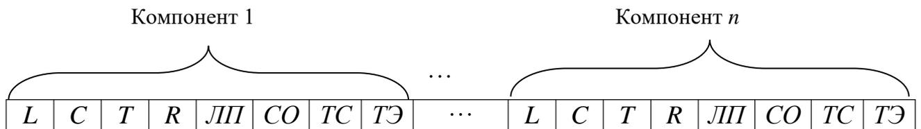
Рисунок 4.14 – Кодирование секции аттенюатора вектором решений
