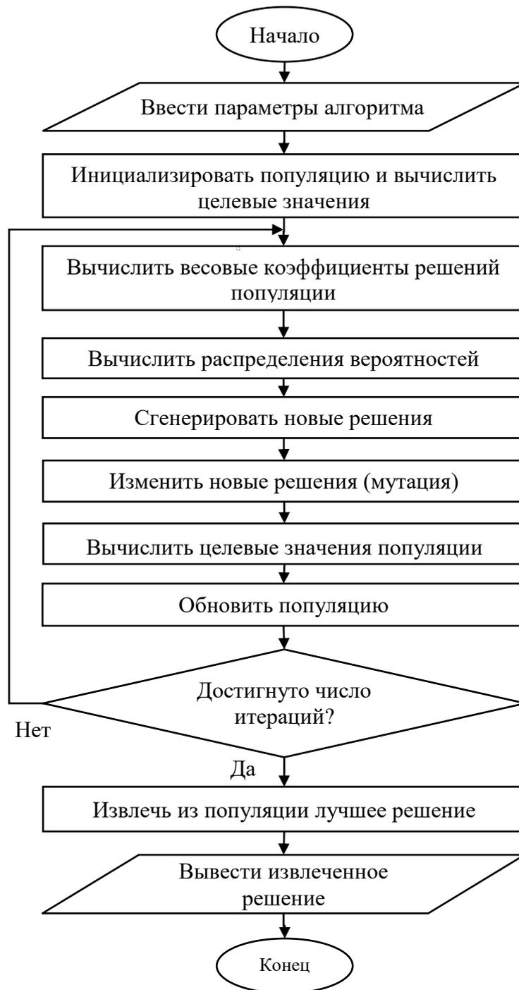
Рисунок 2.10 – Схема алгоритма PDT
