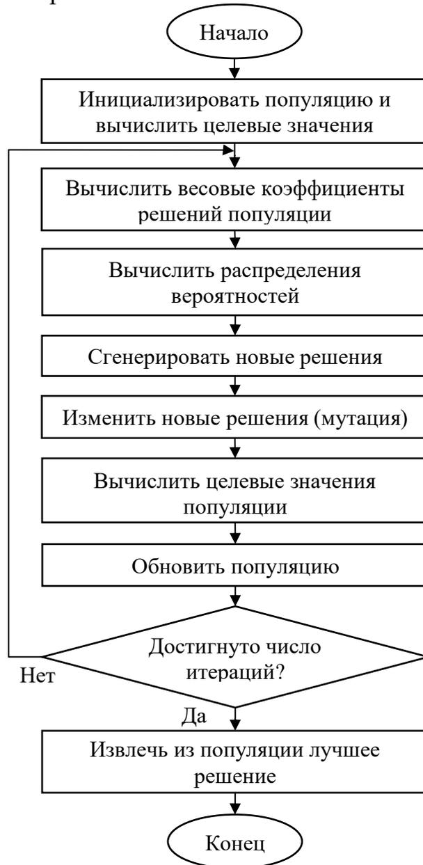
Рисунок 5 – Схема алгоритма PDT
