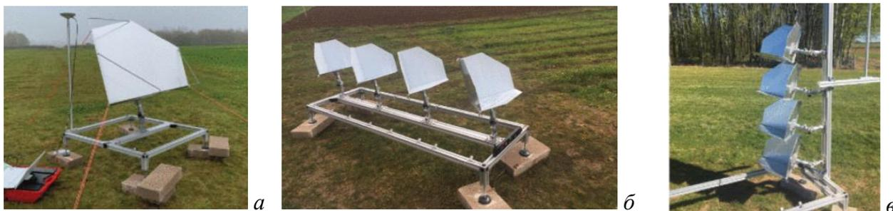
Рисунок 1.20 – Урезанные УО (а) и размещение 4 урезанных УО по горизонтали (б) и вертикали (в) для замены больших УО на практике
