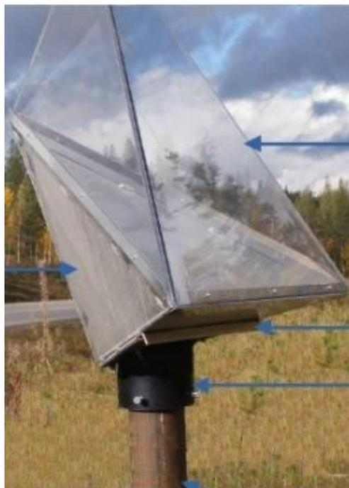
Рисунок 1.15 – ТУО с пластиковой защитой от осадков [127]
