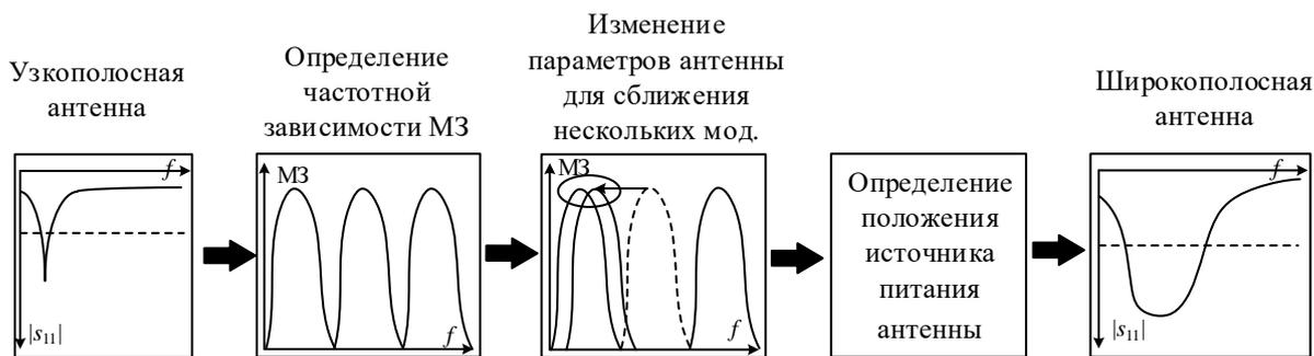
Рисунок 1.3 – Схема расширения диапазона частот антенны с помощью ТХМ
