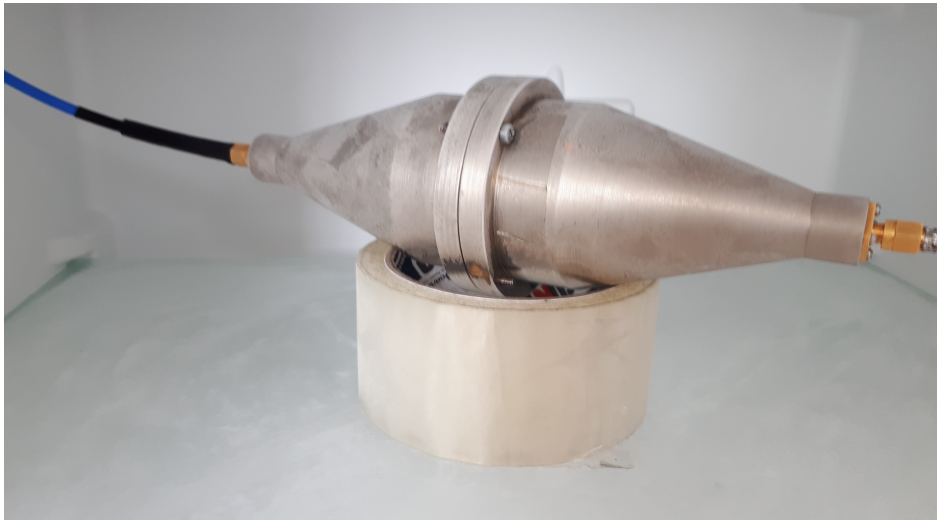
Рисунок 2.21 – Коаксиальная камера с исследуемым объектом внутри морозильной камеры
