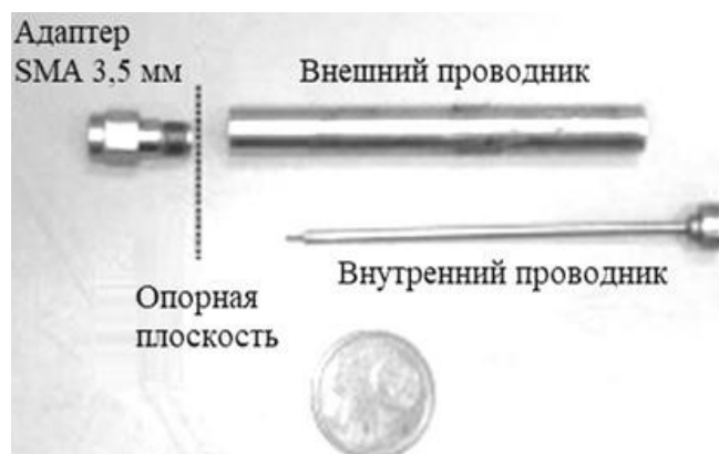
Рисунок 1.4 – Конструкция коаксиального зонда [93]
