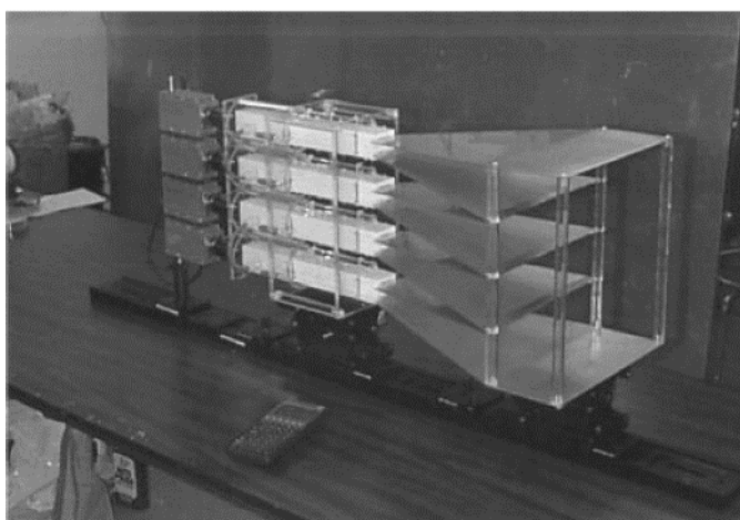
Рисунок 1.18 – Решетка четырех ТЕМ рупоров в источнике СШП излучения Air Force Research Laboratory [21]
