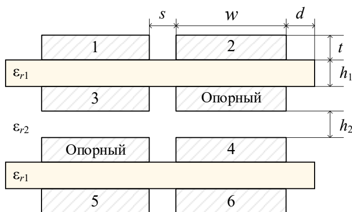
Рисунок 3.2 – Поперечное сечение защитного устройства №1
