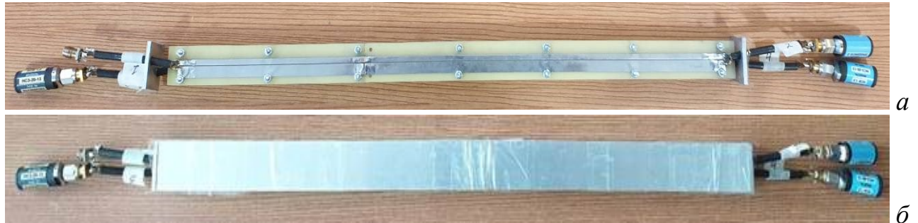
Рисунок 2.39 – Макет устройства защиты без электромагнитного экрана (а) и с ним (б)
