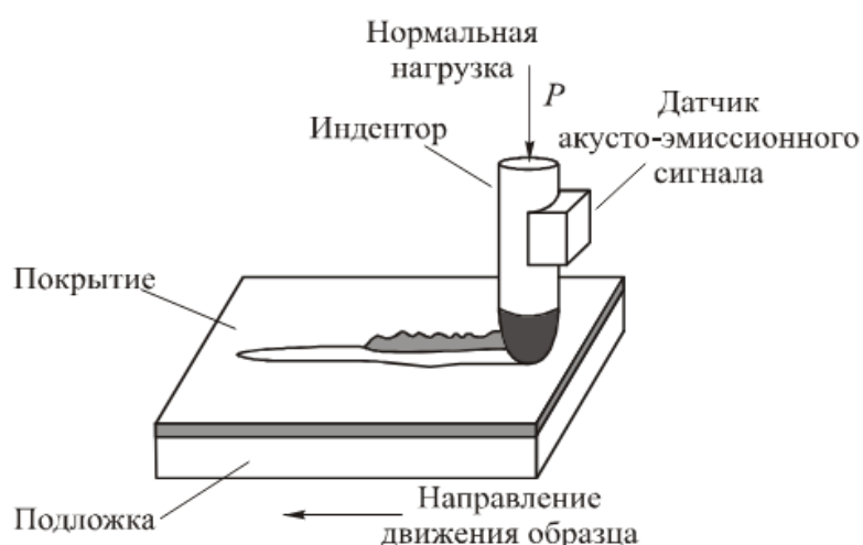
Рисунок 2.18 – Схема контроля адгезионной прочности покрытия методом скретч-тестирования (царапания)
