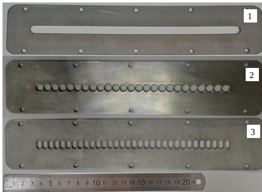
Рисунок 2.8 – Внешний вид вставок в анод. 1 – с протяженным отверстием 220 \times 10 \text{ мм}^2 , 2 – с серией из 25 отверстий диаметром 8 мм, 3 – с серией из 32 протяженных отверстий длиной 9 мм и шириной 6 мм
