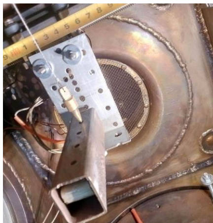
Рисунок 2.19 – Фотография коллектора электронов для измерения распределения плотности тока пучка
