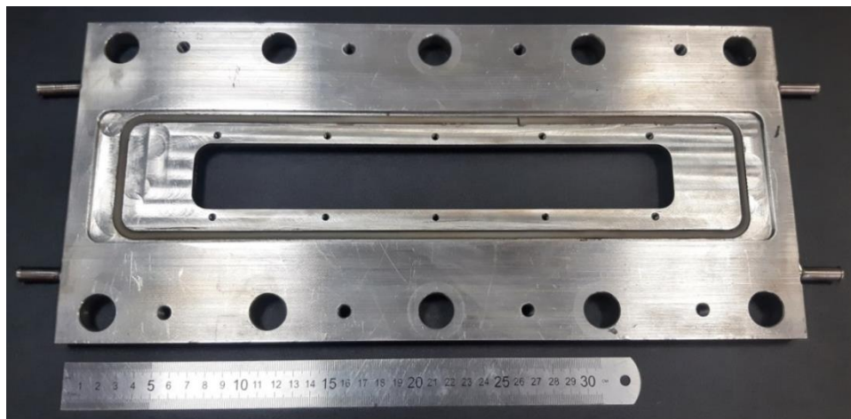
Рисунок 2.7 – Внешний вид анода основного разряда
