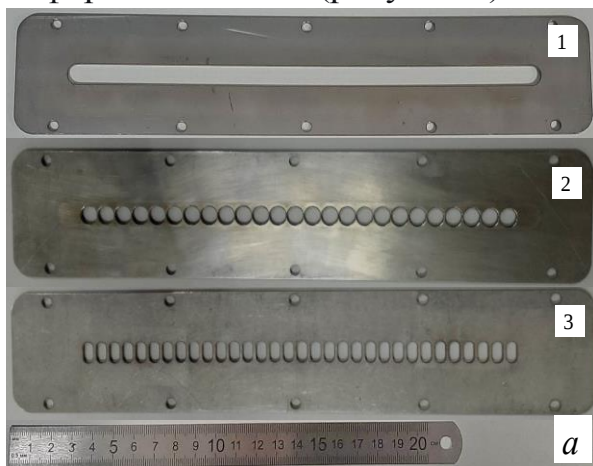
Рисунок 8 – Внешний вид вставок в анод – а и измеренное значение температуры в средней части вставки при работе в течение 30 минут при токе разряда 300 мА – б. Конфигурация вставок: 1 – с протяженным отверстием 220 \times 10 \text{ мм}^2 , 2 – с серией из 25 отверстий диаметром 8 мм, 3 – с серией из 32 протяженных отверстий длиной 9 мм и шириной 6 мм
