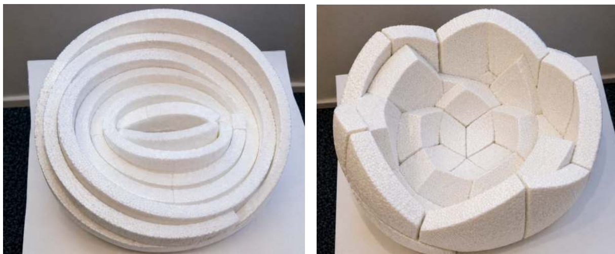
а) ЛЛ из 8 слоёв вспененной смеси б) ЛЛ из 4 слоёв пенополистирола
