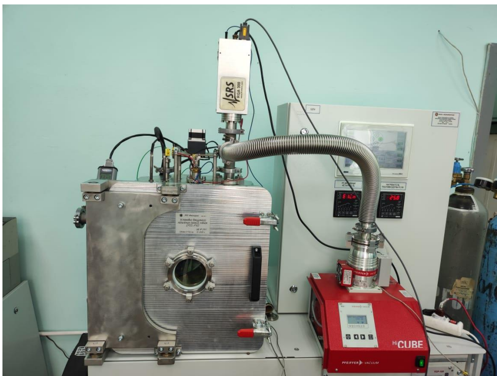
Рисунок 2.3 – Внешний вид экспериментальной установки при измерении массы ионов в плазме газового разряда
