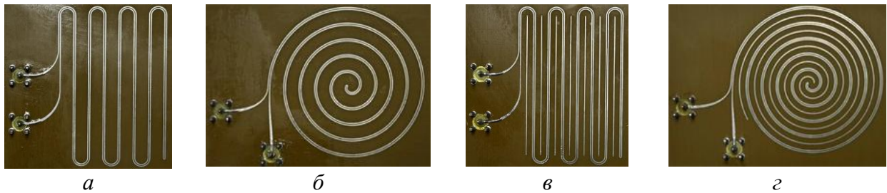
Рисунок 4.1 – Вид сверху изготовленных прототипов 1 (а), 2 (б), 3 (в) и 4 (г) при s_2=10w
