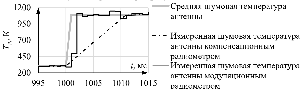
Рисунок 7 – Результаты измерений быстропротекающего радиотеплового процесса компенсационным и модуляционным микроволновыми радиометрами
