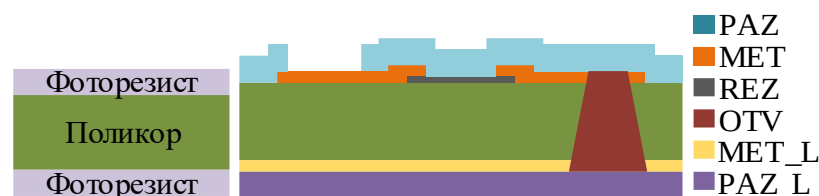
Рисунок 4.4 – Расположение технологических слоев на подложке \text{Al}_2\text{O}_3
