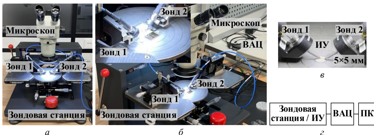
Рисунок 3.2 – Зондовая станция (а), установка для измерения S -параметров ИС (б), ИС с подключенными зондами (в) и схема измерительной установки (г)
