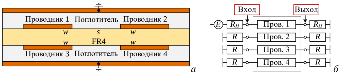
Рисунок 3.4 – Поперечное сечение (а) и схема включения (б) четырёхпроводного З-С МФ с магнитодиэлектрическими слоями
